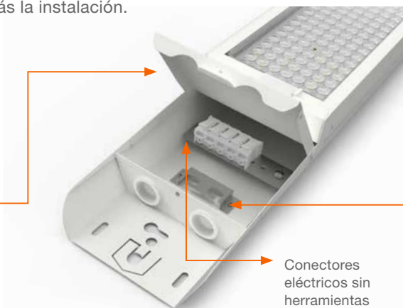
Tapas de final de tramo abiertas/cerradas sin herramientas que dan acceso a los conectores eléctricos
