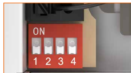
Interruptor DIP para fácil configuración de pasos de potencia
