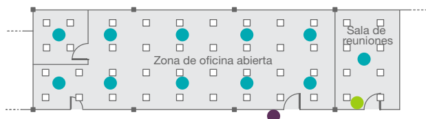
Plano de oficinas: Ajuste automático a la luz diurna y el uso de la sala mediante sensores
